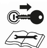
Desligue o motor e remova a chave do trator antes de realizar trabalho de manutenção ou reparo no equipamento.
