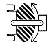
Não transite em rodovias ou estradas pavimentadas. Nas curvas fechadas, evite que as rodas do trator toquem o cabeçalho.
