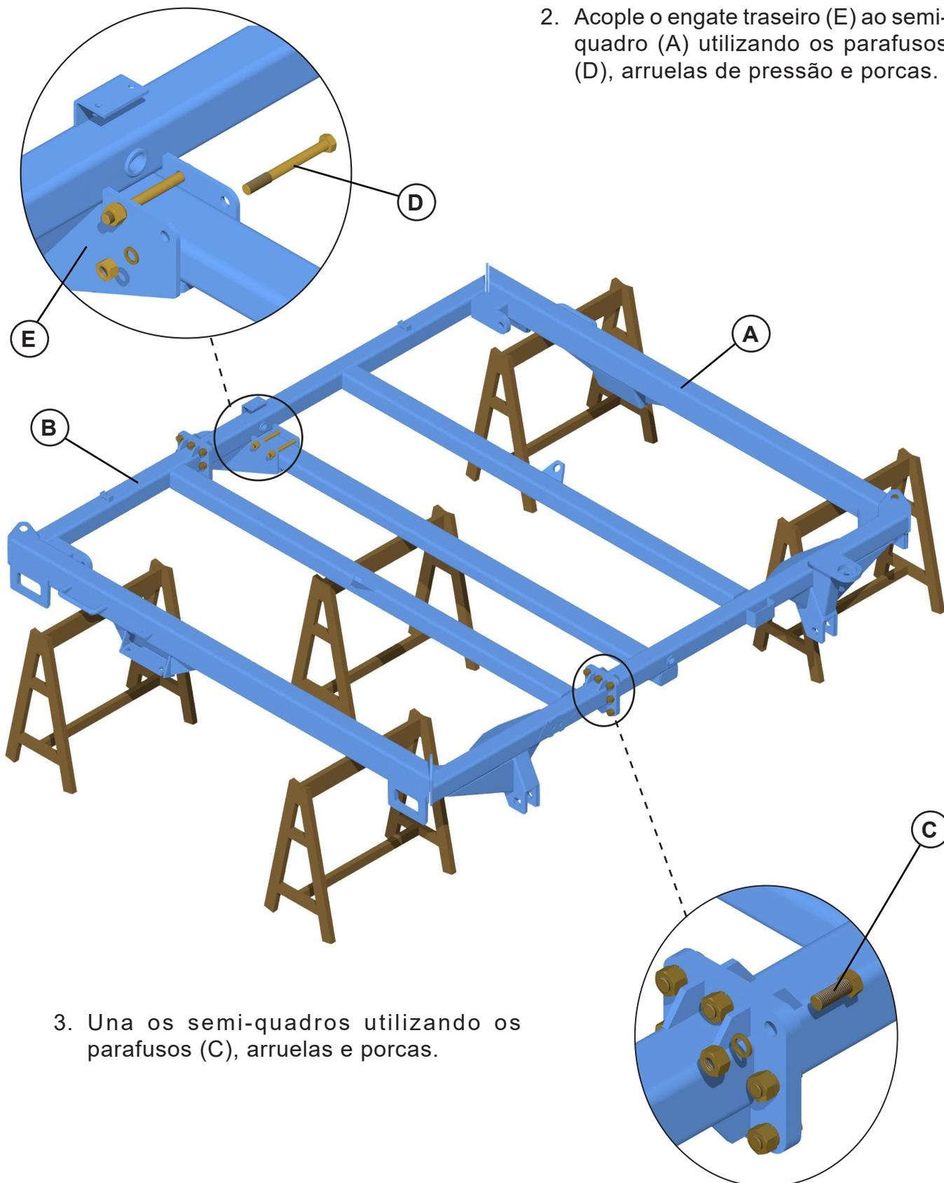
3. Una os semi-quadros utilizando os parafusos (C), arruelas e porcas.
