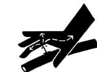
Não verifique vazamentos no circuito hidráulico com as mãos, a alta pressão pode provocar grave lesão.
