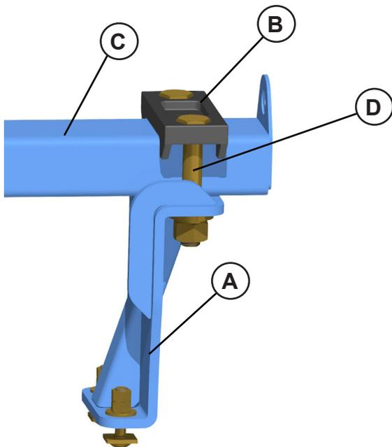
1. Monte os fixadores das sapatas (B) e sapatas (A) no tubo (C) utilizando parafusos (D), arruelas lisas, arruelas de pressão e porcas, mas não aperte totalmente, para facilitar seu posicionamento.
